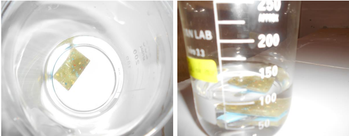
Figure V.10 : Immersion du stratifié dans une eau de mer et dans un acide sulfurique.
