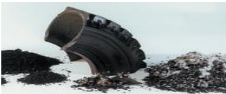
Figure 3.2 Pneus usés transformés en granulats de caoutchouc. Il est plus facile de broyer les matériaux élastiques à basses températures.
