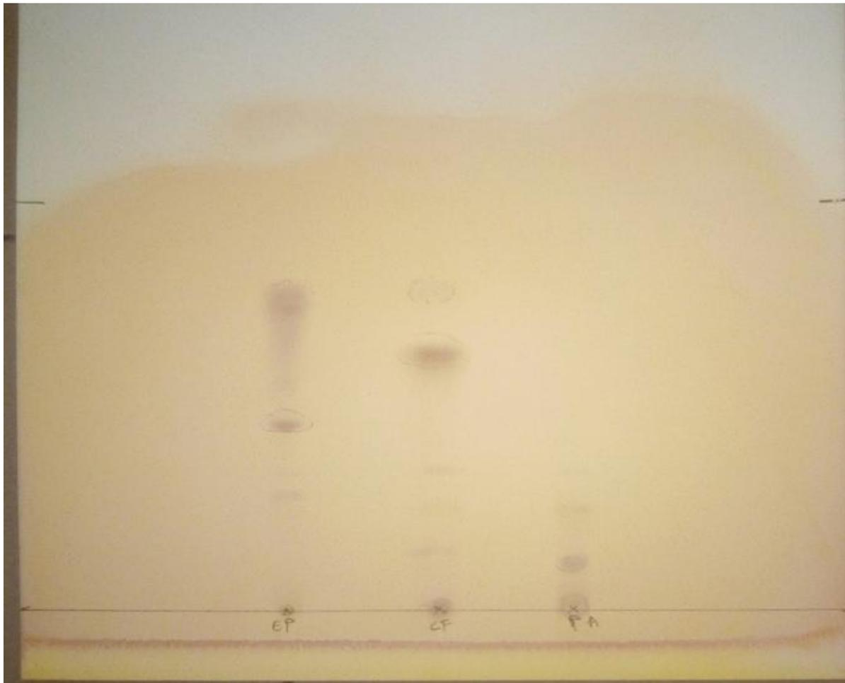
**Figure 14** : profils chromatographique avec comme phase mobile (130ml d'hexane, 20 ml d'acide formique et 80ml de Diethylether).
