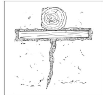
Figure 4.15 : Mise en place d'une planche répartitrice de charges.
