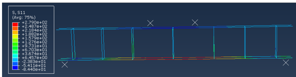
Figure III.1 : Etat des contraintes dans les aciers du témoin.
