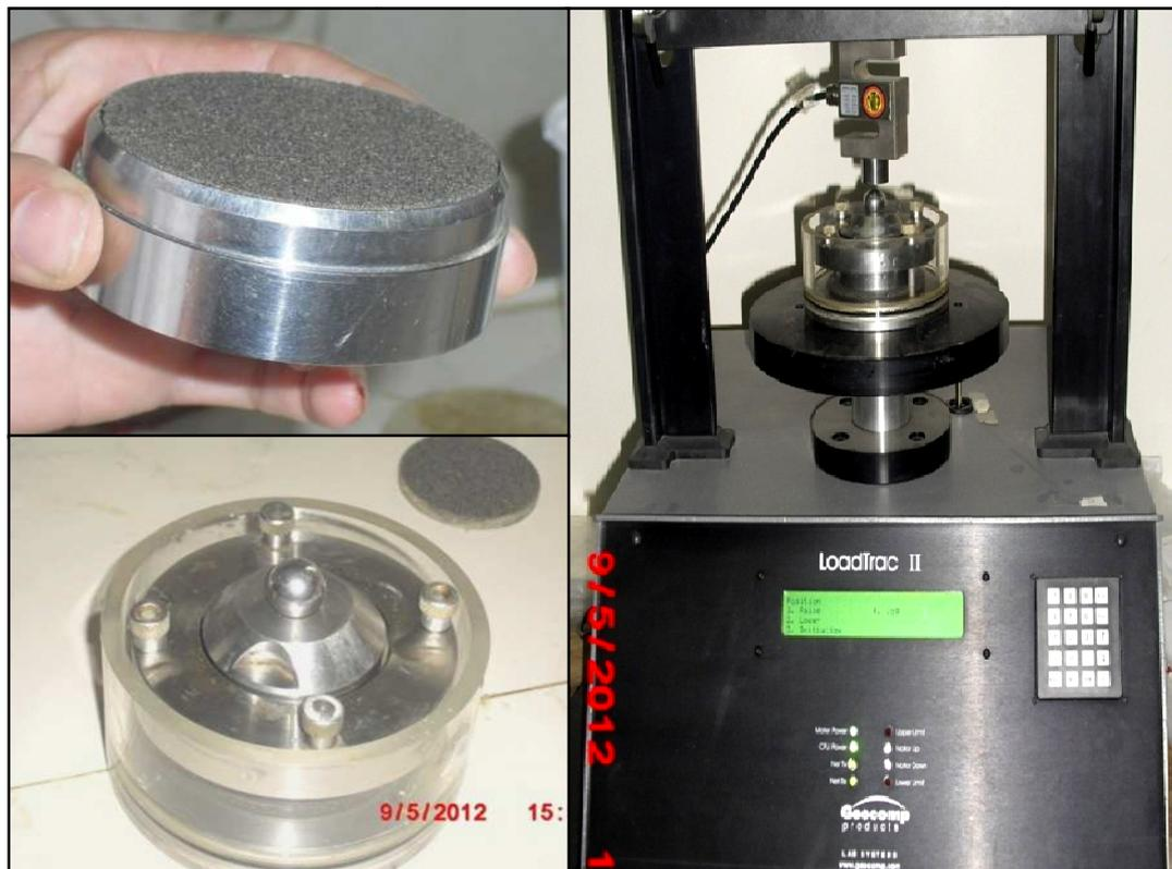
*Figure IV.10 : Dispositif utilisé pour l'essai d'œdométrieque.*
