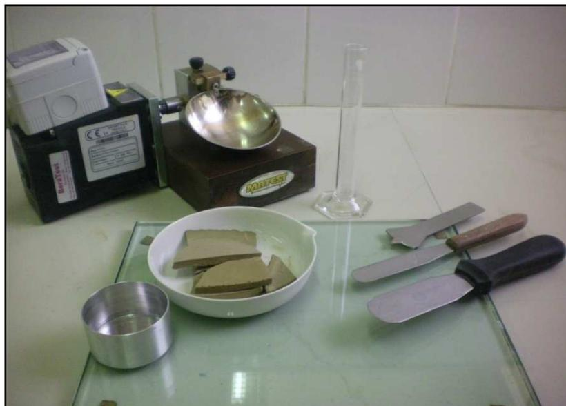
Figure IV.4: Appareil de Casagrande électrique.
