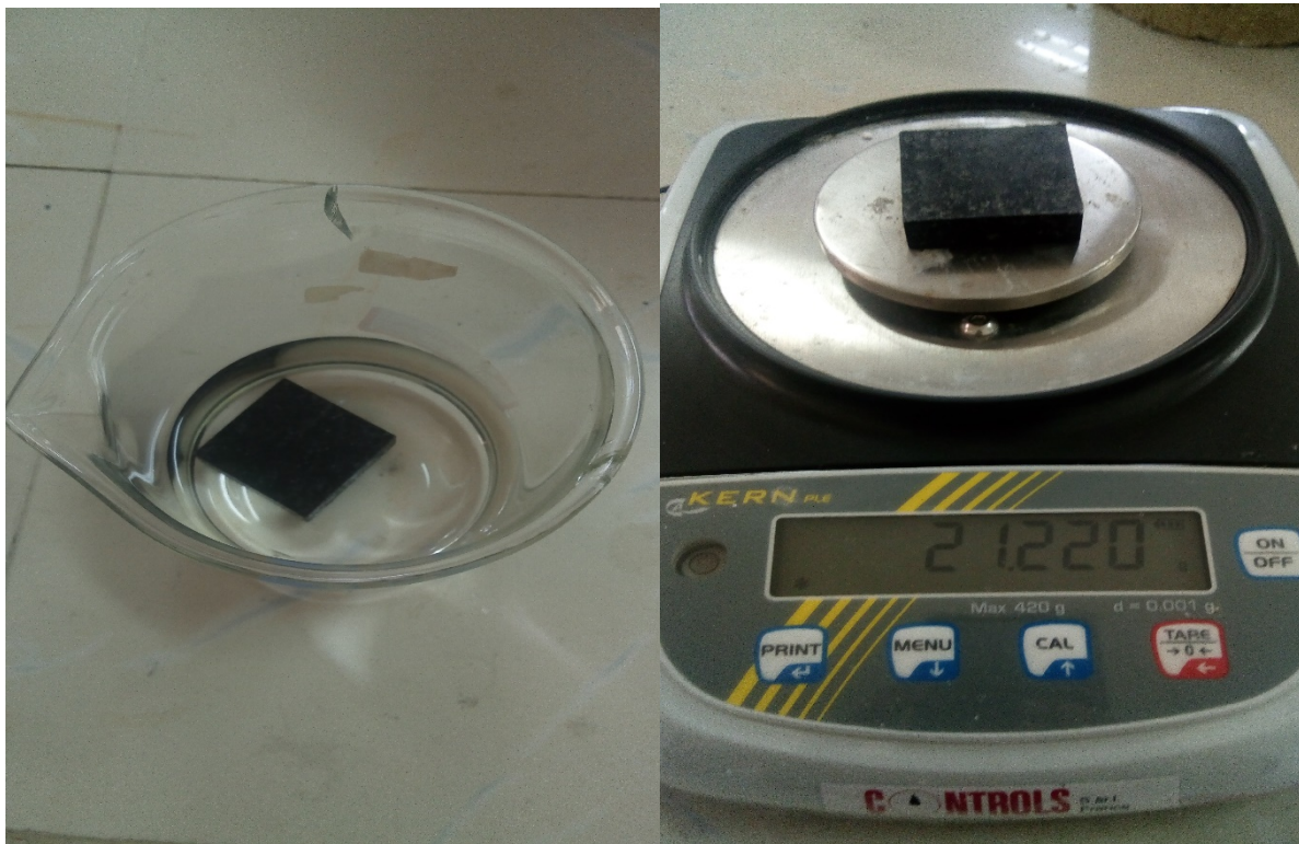
FigureIV.9a l'immersion de la pastille dans de l'eau distillé
