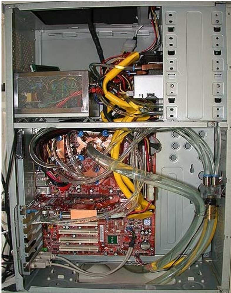
Figure II.4. Refroidissement par eau
