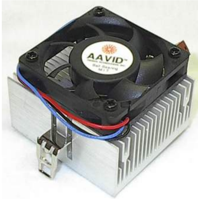
Figure II.5. Refroidissement par air
