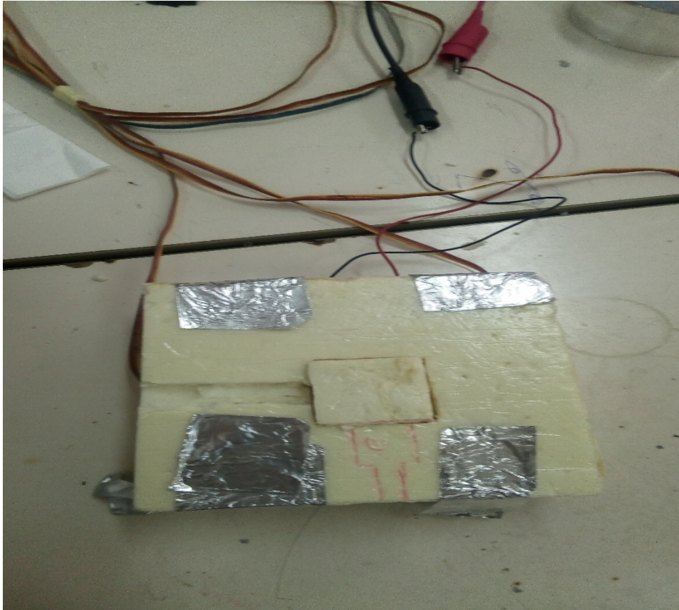
figIV.21 calcule de température sur le Peltier sans refroidissement
