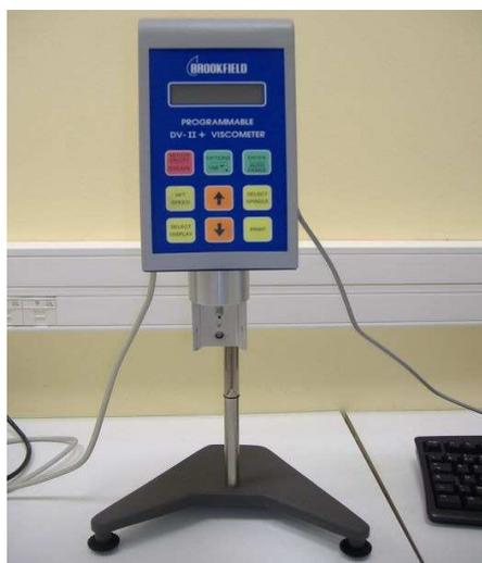
**Figure 6 : Viscosimètre Brookfield**
