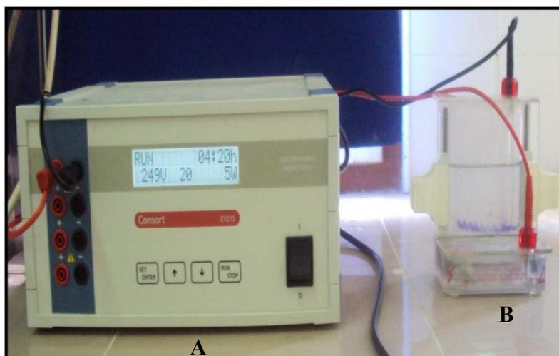
**Figure 13 : Photographie de l'unité d'électrophorèse sur mini-cuve Hoeffler SE 200.**
