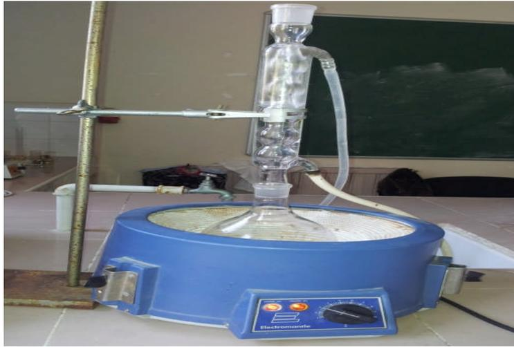
**Figure 21:** Réfrigérant à reflux
