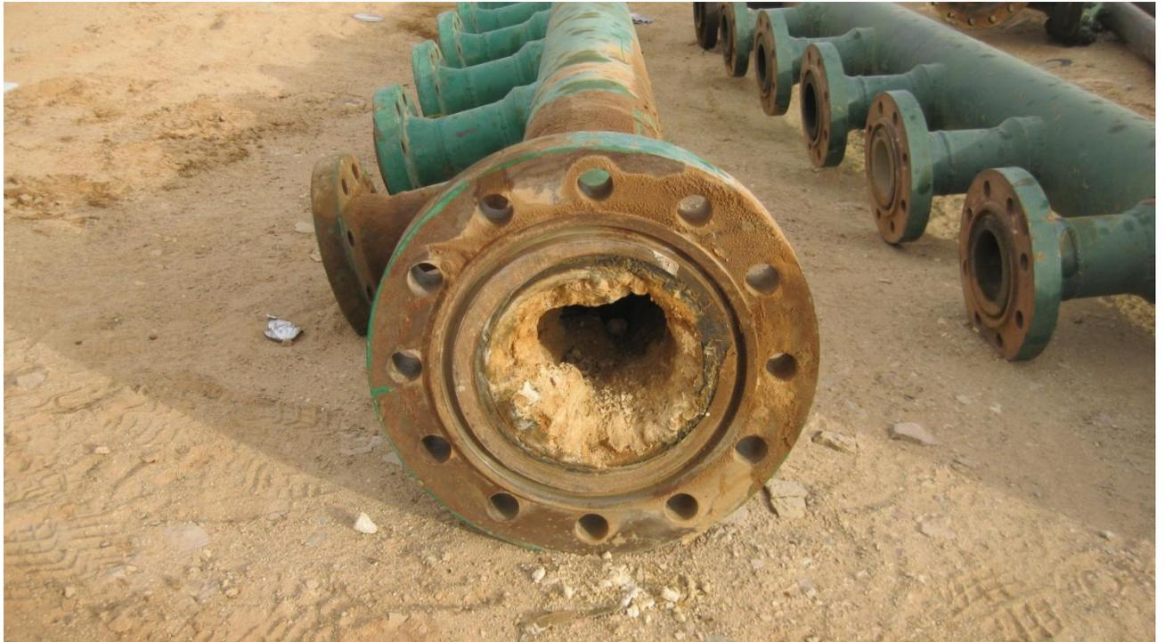
**Figure 2:** Photographie d'un pipe bouché par le dépôt
