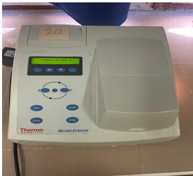
Photo 8 : spectrophotomètre pour mesurer la DO
