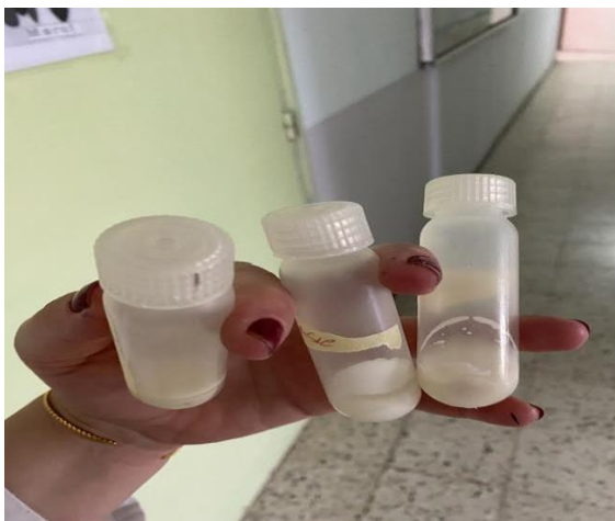
Photo 10 : la crème à la surface des tubes après centrifugation
