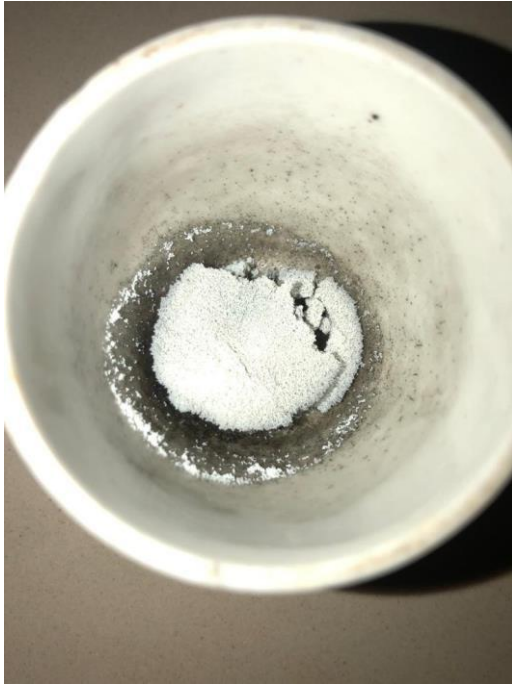
Photo 3 : résultats des cendres des échantillons du lait.
