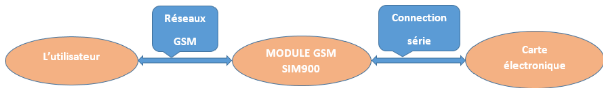
Figure III. 16: Schéma du système de commande GSM
