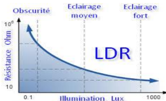
Figure II. 8: Graphe de la résistance en fonction de la lumière.
