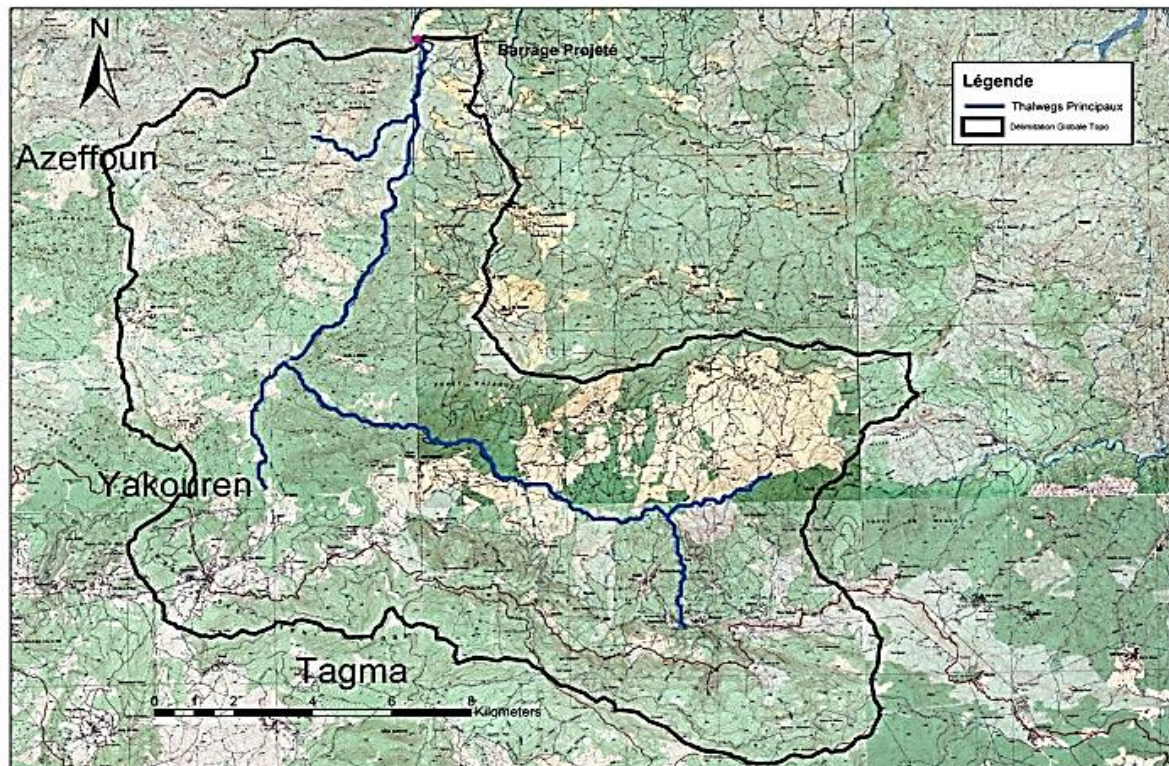
Figure IV.1 : Délimitation du Bassin Versant de SIDI KHELIFA à partir des Cartes Topographiques au 1/25 000
