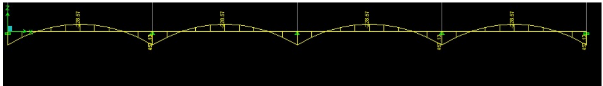
Figure VIII-17 : Diagramme des moments fléchissant à ELU.
