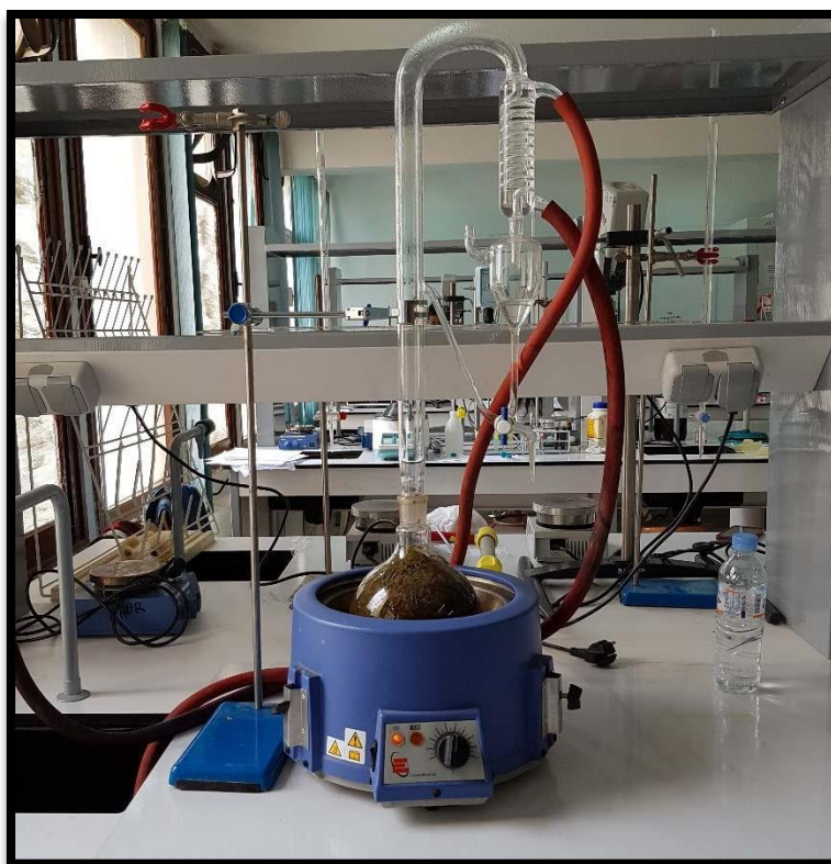
Figure 2.3: Extraction de l'huile essentielle par un appareil de type : Clevenger
