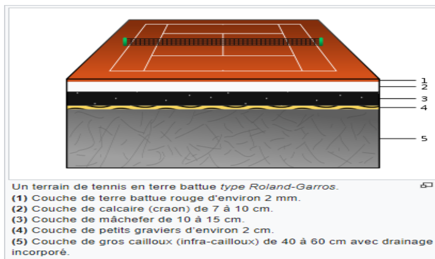
Figure1.17 : coupe des couches du terrain de tennis.
