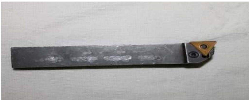
**Figure V.7** : outil à charioter utilisé pour l'ébauche.
