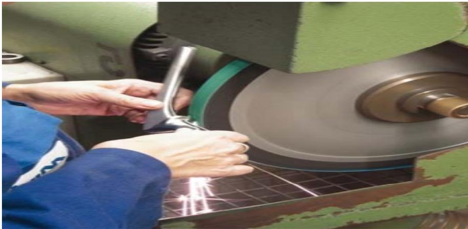
Figure I.17 : polissage manuel.
