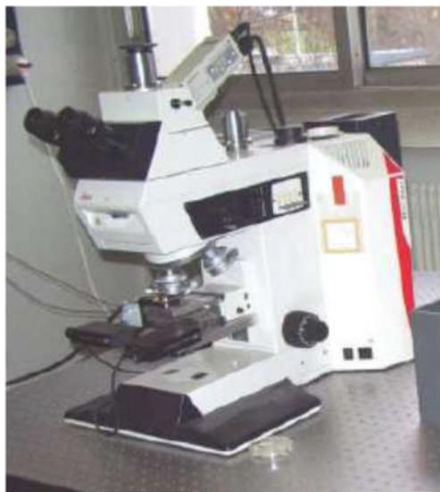
**Figure III.14 :** microscope à éclairage oblique.
