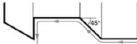
**Figure II.13.B :** Choix de l'angle de pointe en fonction de la géométrie de la surface à usiner.
