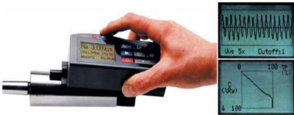
**Figure III.13 :** sortie numérique et graphique d'une mesure d'état de surface.
