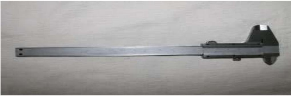
**Figure V.3 :** pied à coulisse utilisé.
