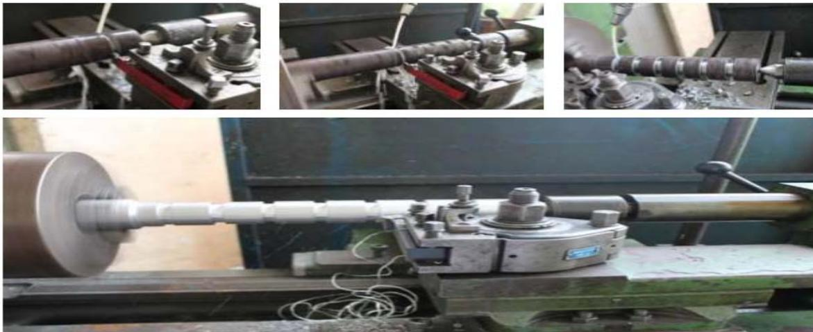
**Figure V.5** : Préparation des éprouvettes d'essais
