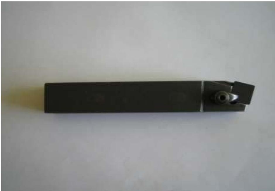
**Figure V.2.c** : plaquette montée sur porte outil utilisé.
