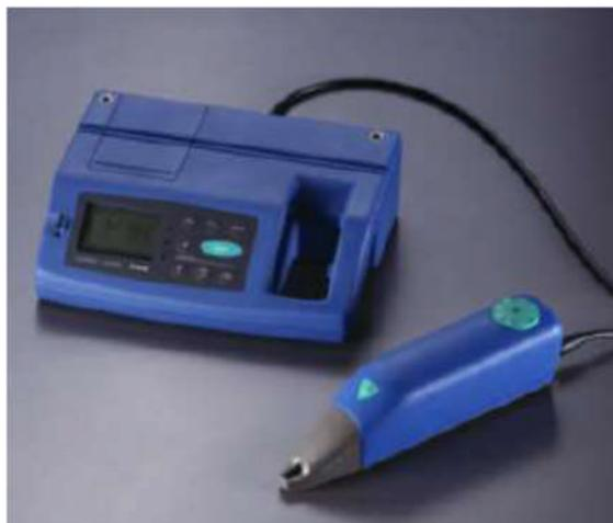
**Figure III.12** : appareil électronique de mesure a palpeur.
