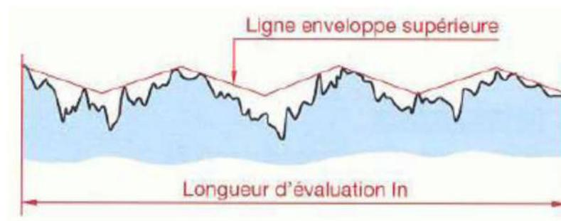
**Figure III.5.B** : ligne d'enveloppe supérieure.
