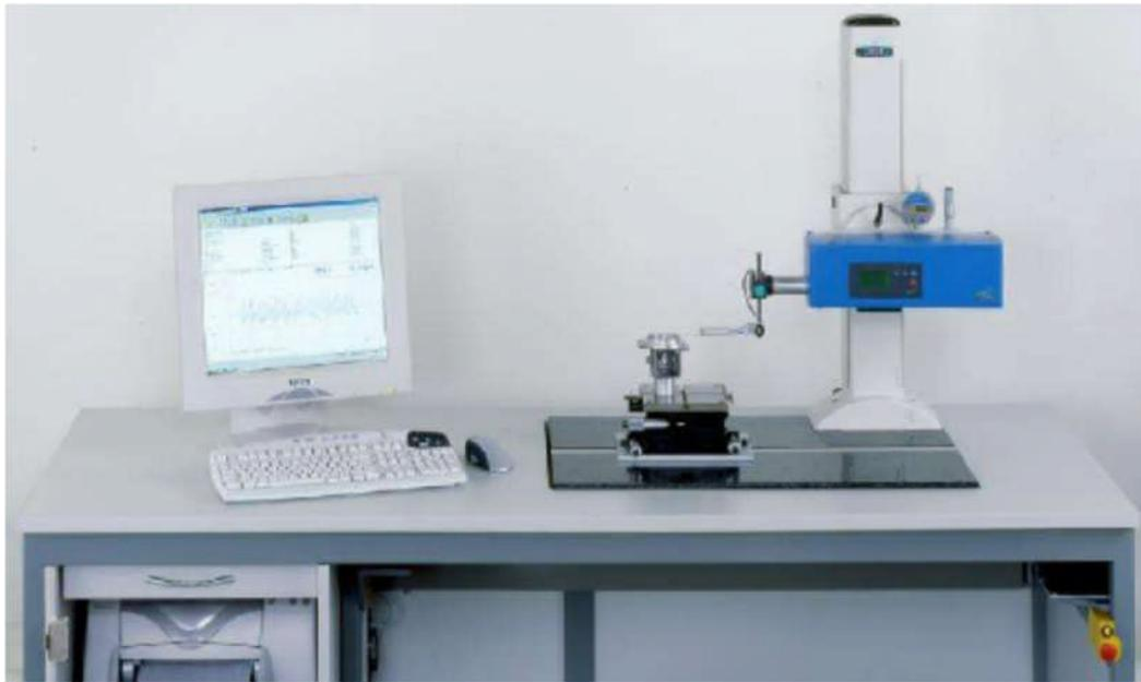
**Figure III.11** : appareil électronique de mesure a palpeur et patin.
