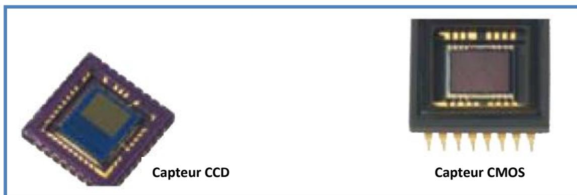
**Figure II.9** : Capteurs CCD et CMOS
