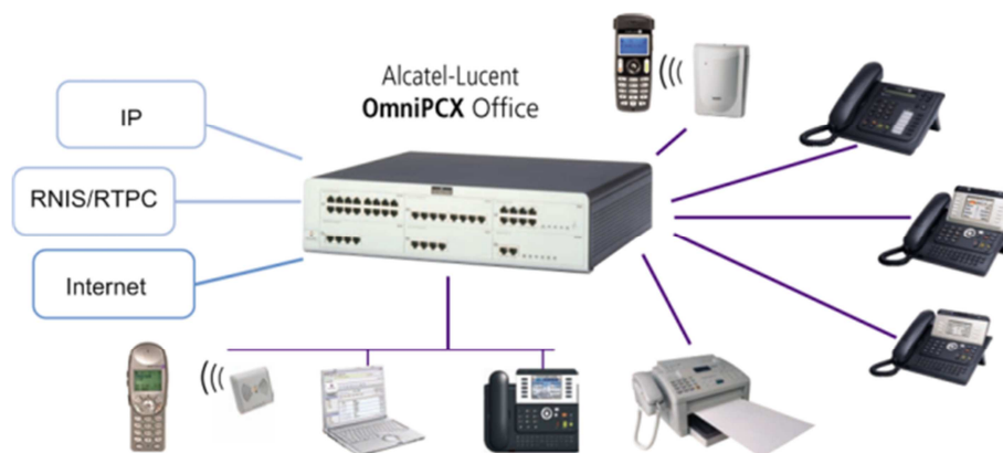
Fig.20: Le système de téléphonie Alcatel-Lucent Omni PCX Office.
