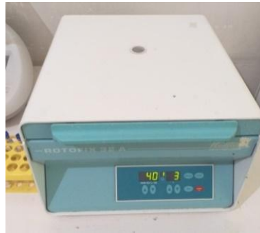
Figure 15 : centrifugeuse (Roto Fix 32A) de 4500 t/min de vitesse
