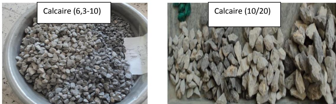
Fig.27. les échantillons du matériau du calcaire utilisé pour cette étude
