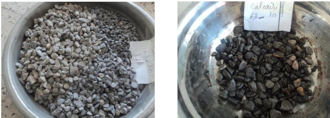
Fig.65 Les échantillons de calcaire de forme sous angulaire avant et après essai
