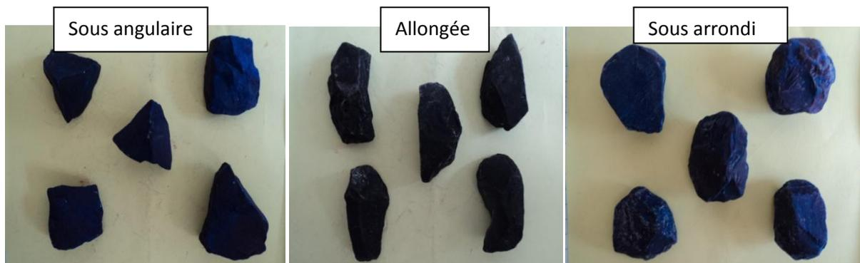
Fig.31.Les différents formes des grains de calcaire
