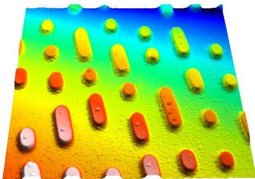
Fig. 4 Surface d'un CD (dimension = 2.17)
