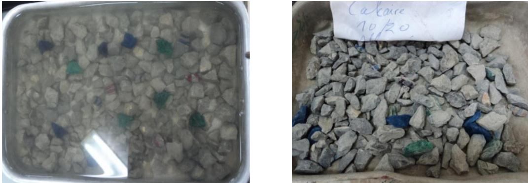
Fig.41 Les échantillons du calcaire avant et après essai de dégradabilité
