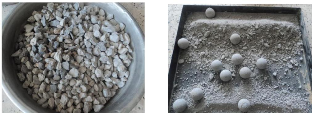
Fig.67 Les échantillons de calcaire de forme sous arrondi avant et après essai
