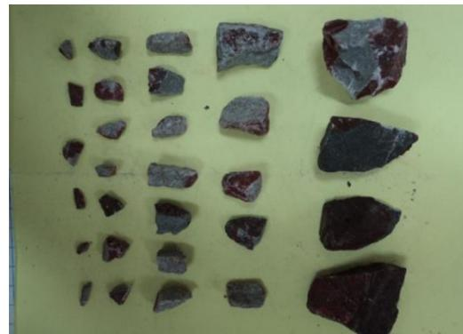
Fig.58 Les échantillons du calcaire de forme sous angulaire avant et après essai
