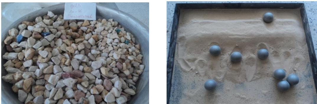
Fig.66 Les échantillons des grains de grés de forme sous angulaire avant et après essai
