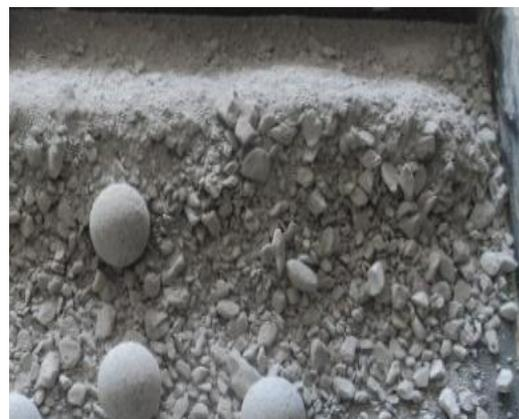
Fig.68 Les échantillons de schiste de forme sous angulaire avant et après essai
