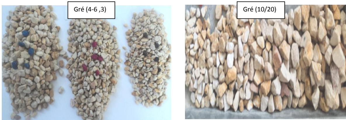
Fig.25. Les échantillons du matériau grés utilisé pour cette étude
