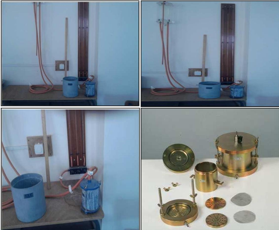
**Figure 33** : Perméamètre de laboratoire
