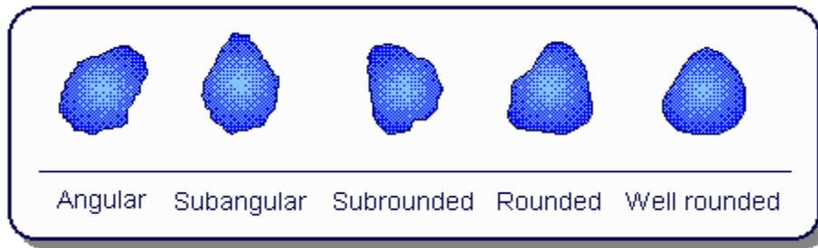
**Fig.30.1.** Les diagrammes les plus utilisés par les géologues pour comparer l'arrondi des grains (RAYMOND, 1995).
