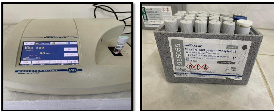
Figure III.10 : Réactifs du dosage des phosphates.
