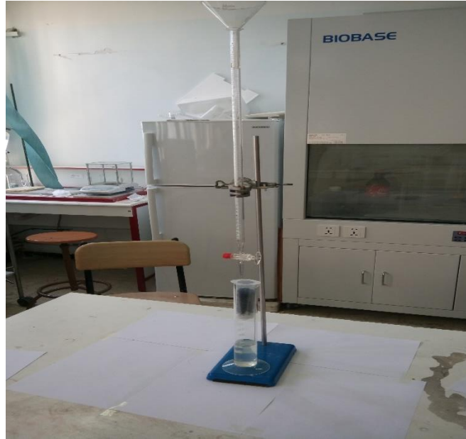
Figure III.5 : Montage de filtre à sable et de charbon actif
