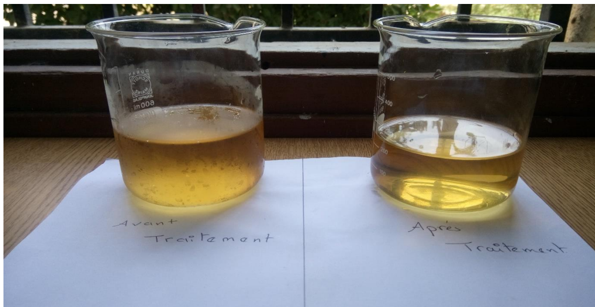
Figure IV.27 : La couleur de lixiviat avant et après traitement par filtre à sable
