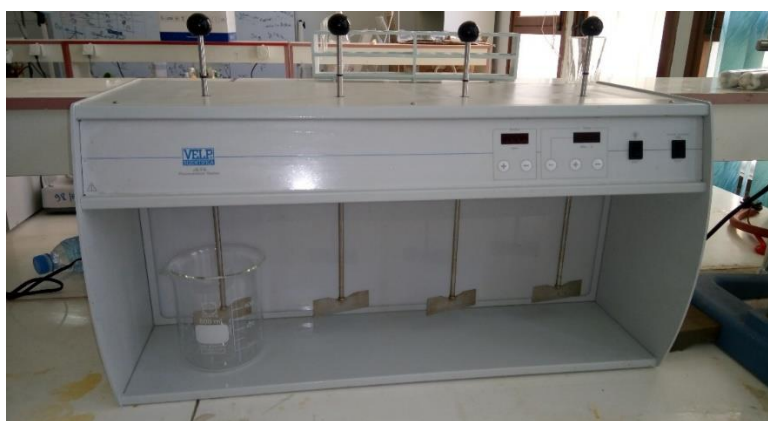
Figure III.2 : Description de dispositif expérimental (jar test)
