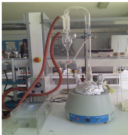
Figure 14 : montage de l'hydrodistillation Type Clevenger (photo originale).
