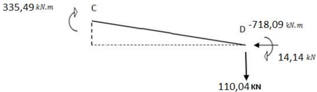
Figure VIII- 6: Sollicitations sur traverse cas de charges ascendantes.
