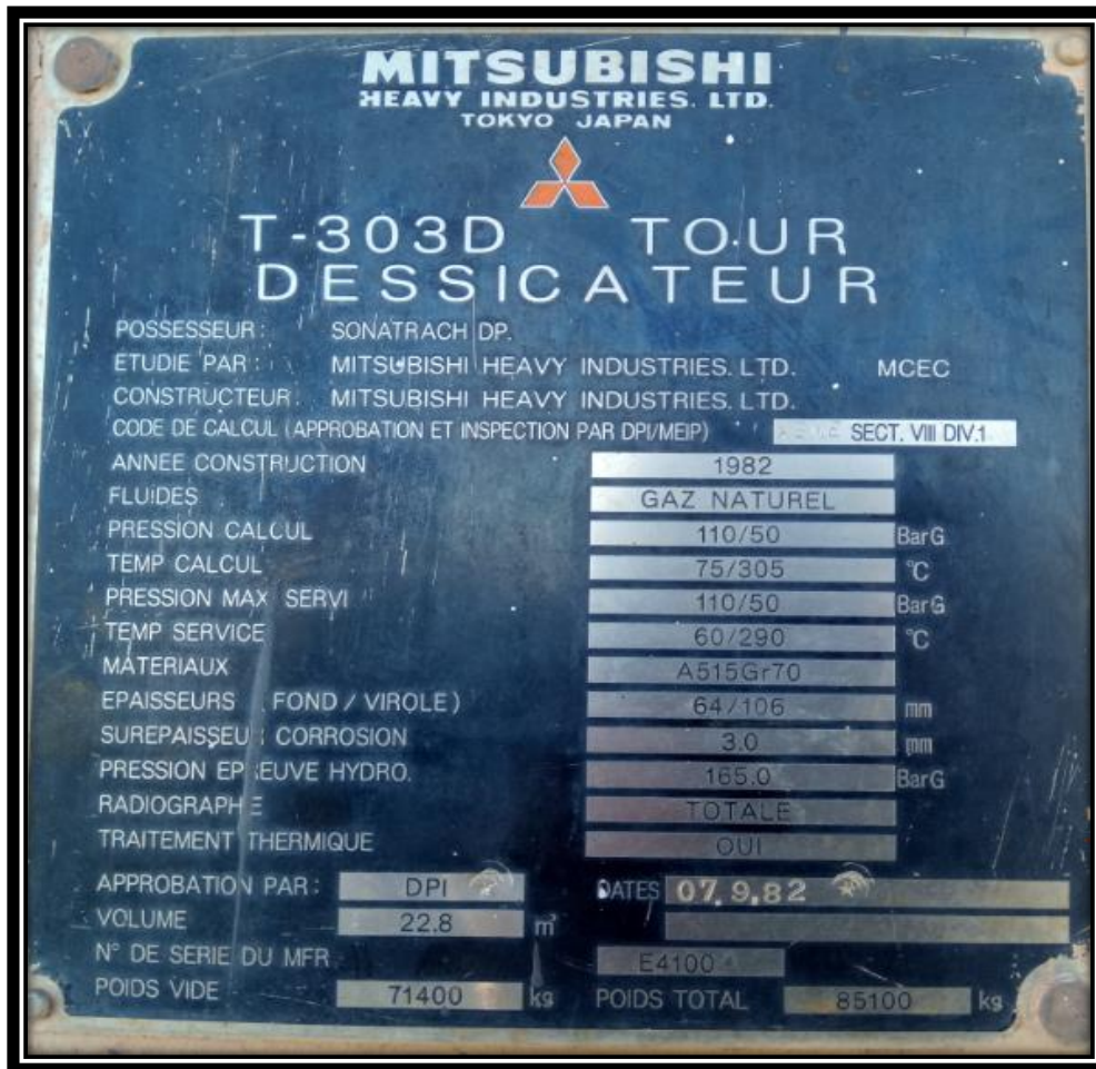
Figure 28 : Plaque signalétique d'une tour de déshydratation.
