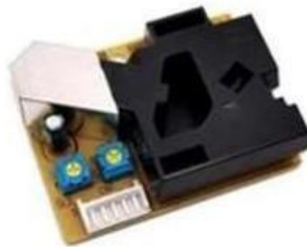
Figure 15 : Capteur de particules DSM501A. [34]
