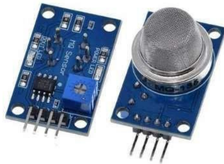
Figure 13 : Capteur de gaz MQ-135. [32]
