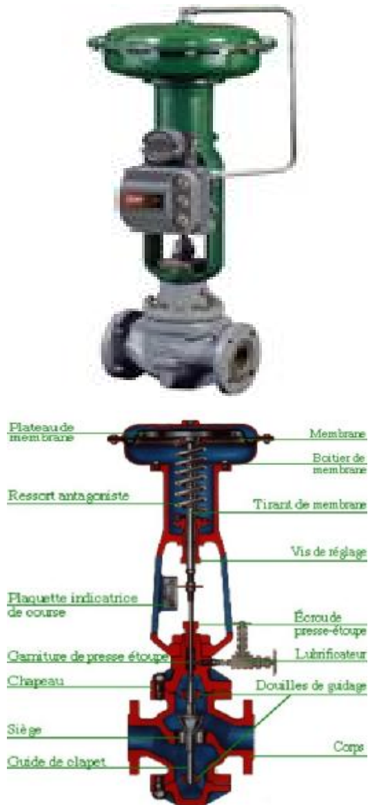
Figure I.6 : Vanne de régulation
