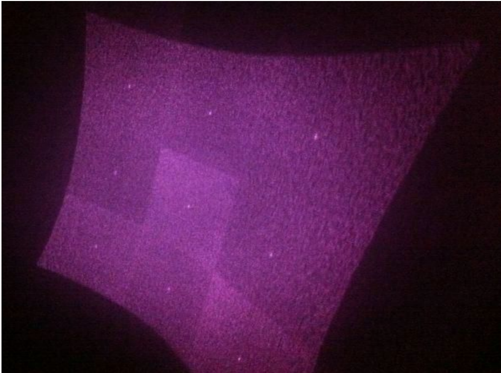
Figure I.22 : Exemple de motif laser projeté par la Kinect.
