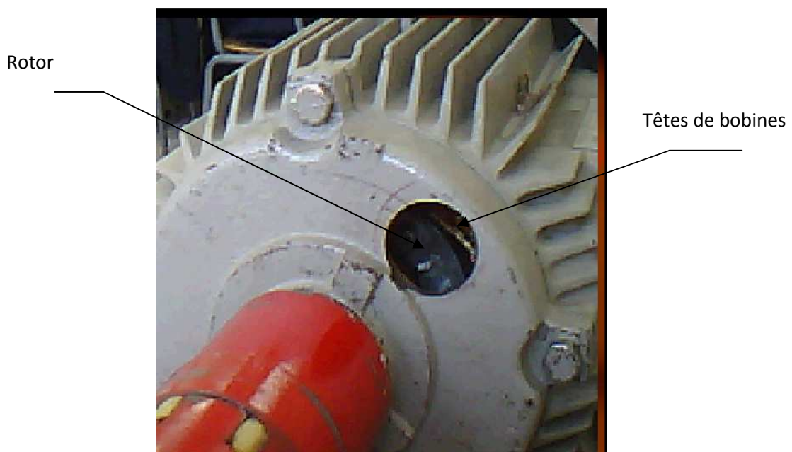
Fig. IV.15 moteur asynchrone avec un trou sur la flasque
