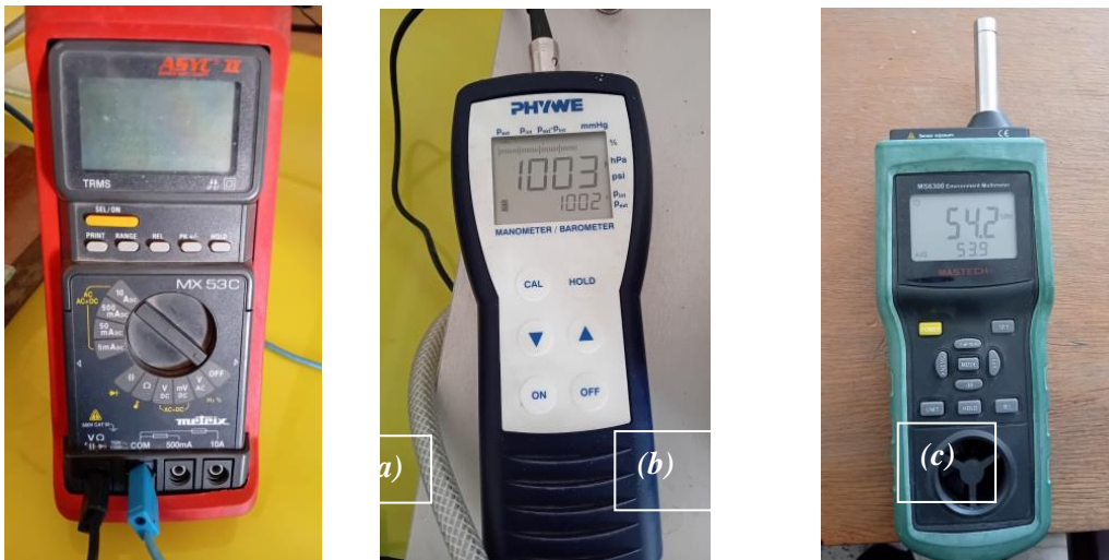
Figure III.4 Appareils de mesures utilisés (a) : Multimètre, (b) : Baromètre avec son capteur de pression, (c) : Hygromètre
