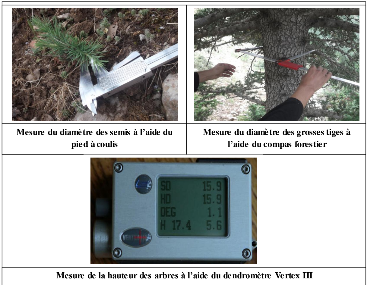
Fig.10 : Différents outils de mesure utilisés sur terrain.
