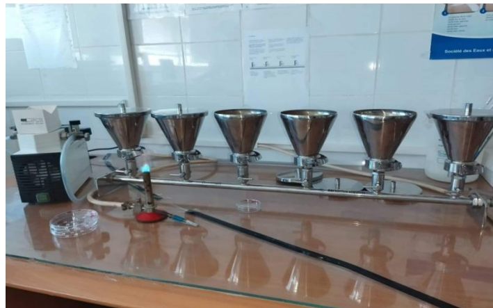
Figure 25 : Dispositif de filtration (photo original)
