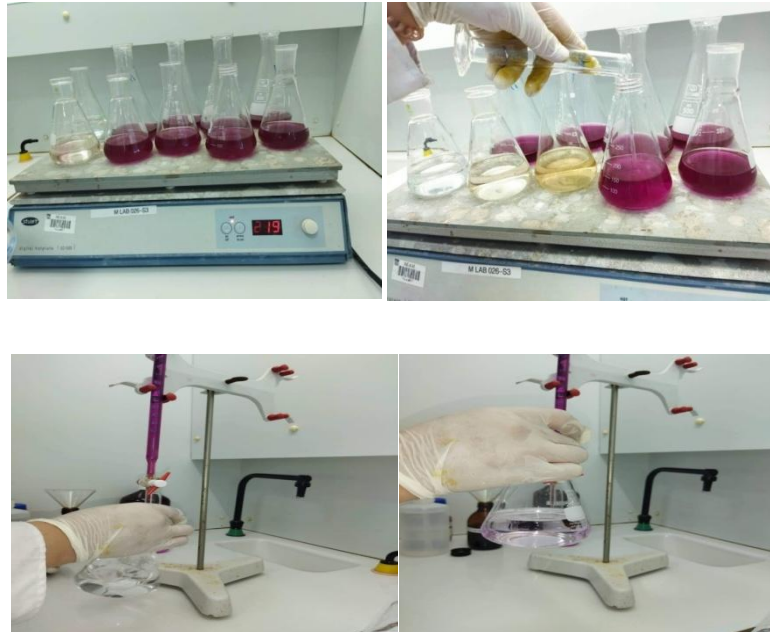
Figure 24: La méthode dosage de la matière organique par le principe de la titrimétrie à chaud. (Photo originel)
