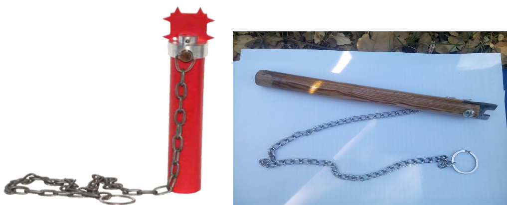
FIGURE 15 : PHOTOS DE RELASCOPE A CHAINETTE
