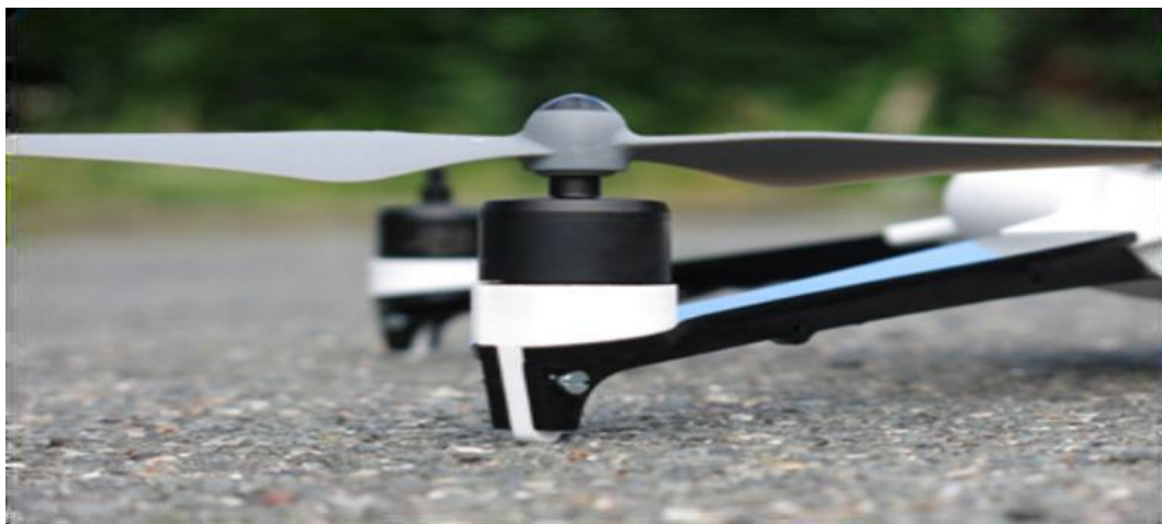
Figure I.13: Drone fabriqué en impression 3D.[4]
