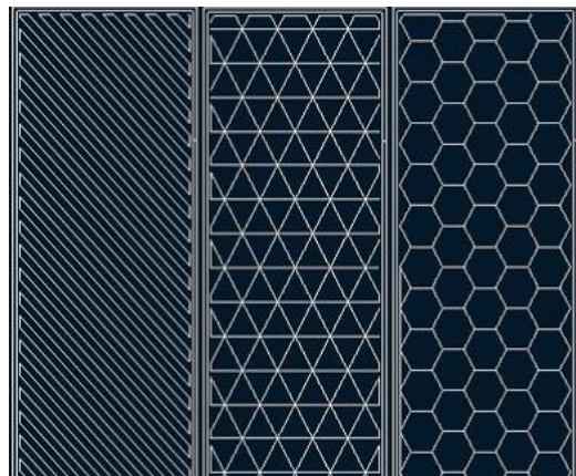
Figure I.8 : Différents dépôts du thermoplastique : linéaire, triangulaire ou nid d'abeille.[9]
