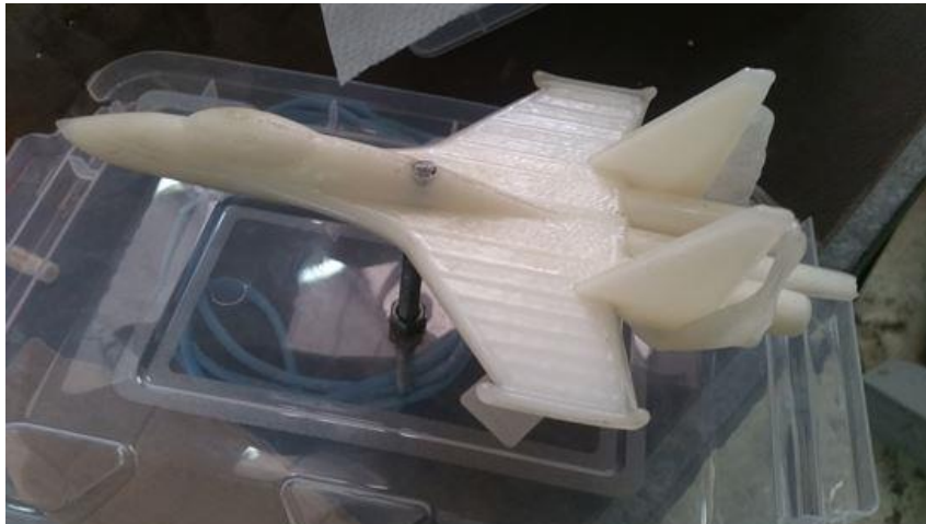
Figure IV.39 : Maquette déformée après traitement à la vapeur d'acétone.
