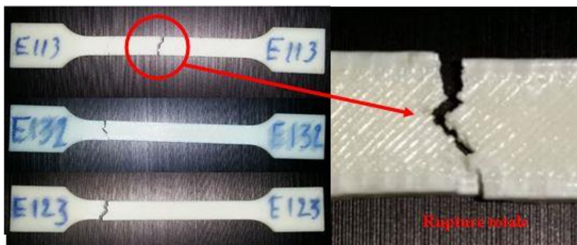
Figure IV.24 : Eprouvettes de la première position à la fin d'essai.
