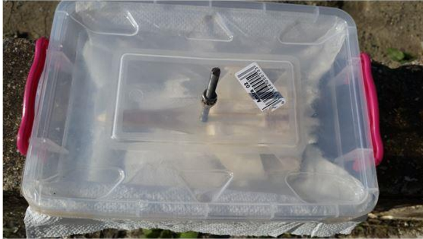
Figure IV.38 : Traitement à la vapeur d'acétone.
