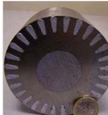
Figure I.11 : Rotor à encoche profonde.
