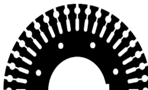
Figure I.9 : Tôle utilisée pour la réalisation d'une cage à double encoche
