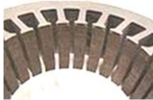
Figure I.3 : Stator feuilleté sans bobinages
