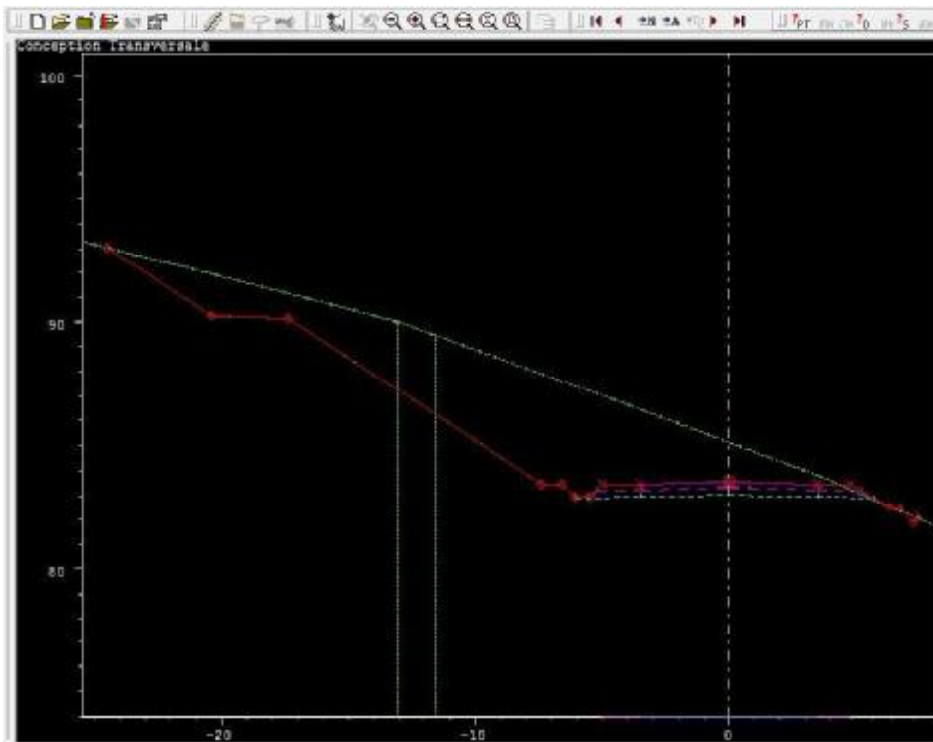
Figure III-11 : Profil en travers en déblai.
