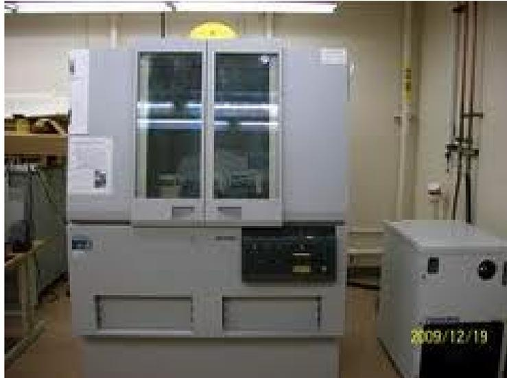
**Figure III.15 : Diffractomètre Philips X'pert**
