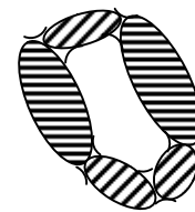
Figure [II.3c] : Les grains soudés par les forces capillaires
