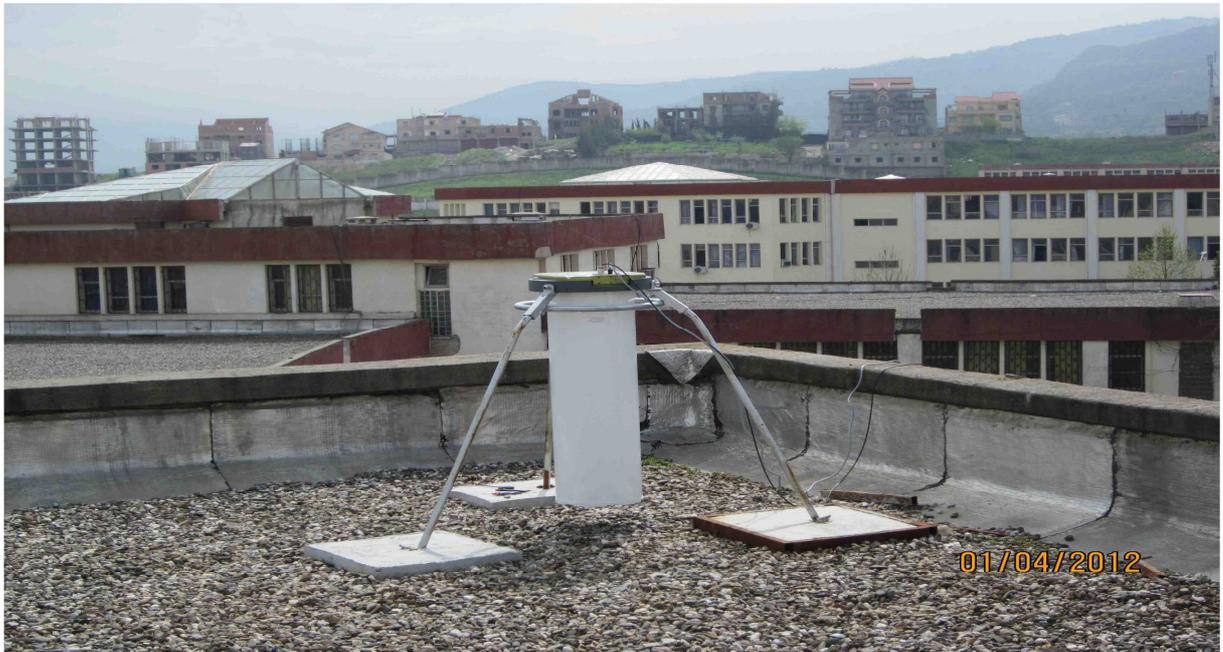
Figure (3.2) : Micro Lidar CE 370-2 sur la terrasse du laboratoire LAMPA
