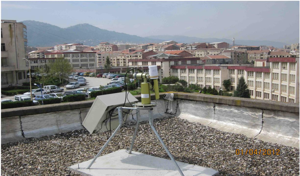
**Figure (3.3)** : photo prise sur la terrasse du laboratoire **LAMPA** d'un photomètre **CE 318**
