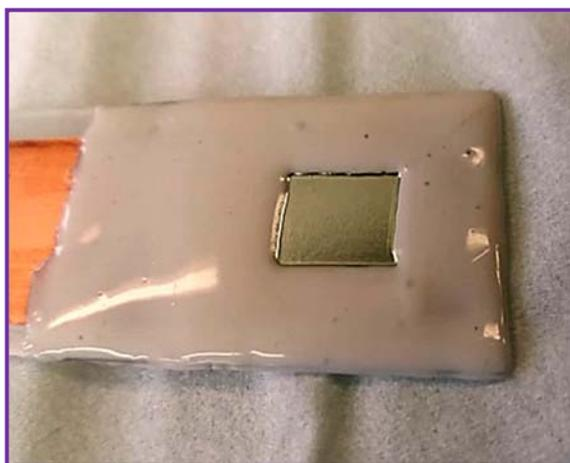
**FIGURE III.17.** Illustration de l'état de surface de l'alumine obtenue après la 2<sup>ème</sup> anodisation. Conditions : Al (99.999%), acide oxalique 0.5 mol/L, 17 °C, 40 V et 17 et 5 h 1<sup>ère</sup> et 2<sup>ème</sup> anodisation.
