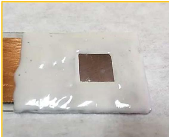
FIGURE III.16. Illustration de l'état de surface de l'aluminium avant toute anodisation.
