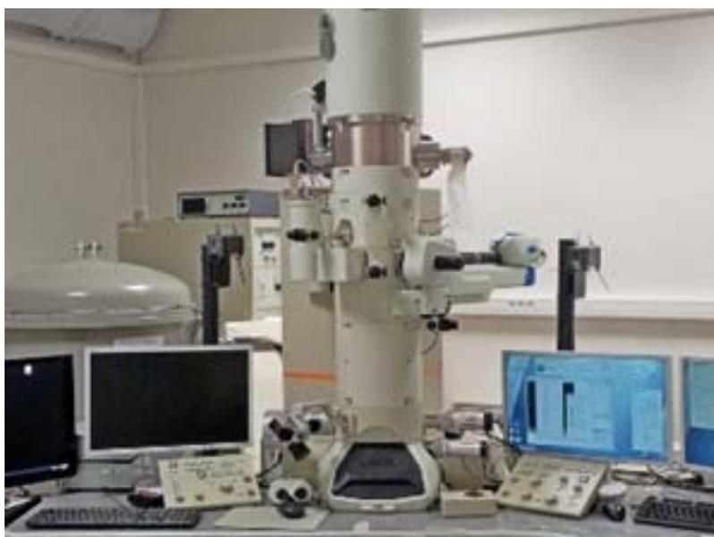
**FIGURE II.16.** Photographie du microscope électronique en transmission JEOL-JEM 2100F.
