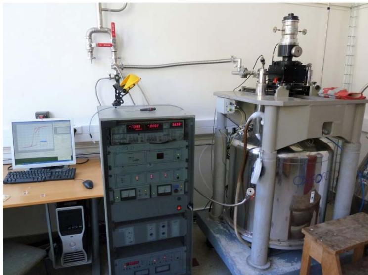
FIGURE II.20. Magnétomètre à échantillon vibrant (VSM-Oxford).
