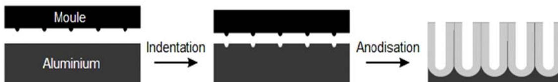
**FIGURE III.3.** Schéma des étapes de la fabrication de l'alumine poreuse idéalement ordonnée par la méthode de la pré-indentation.
