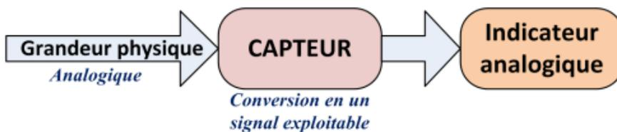
Figure I-12 : Schéma bloc d'un système de mesure
