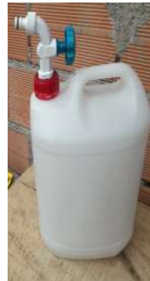
Figure 21 : robinet d'eau sur le bouchant du bidon
