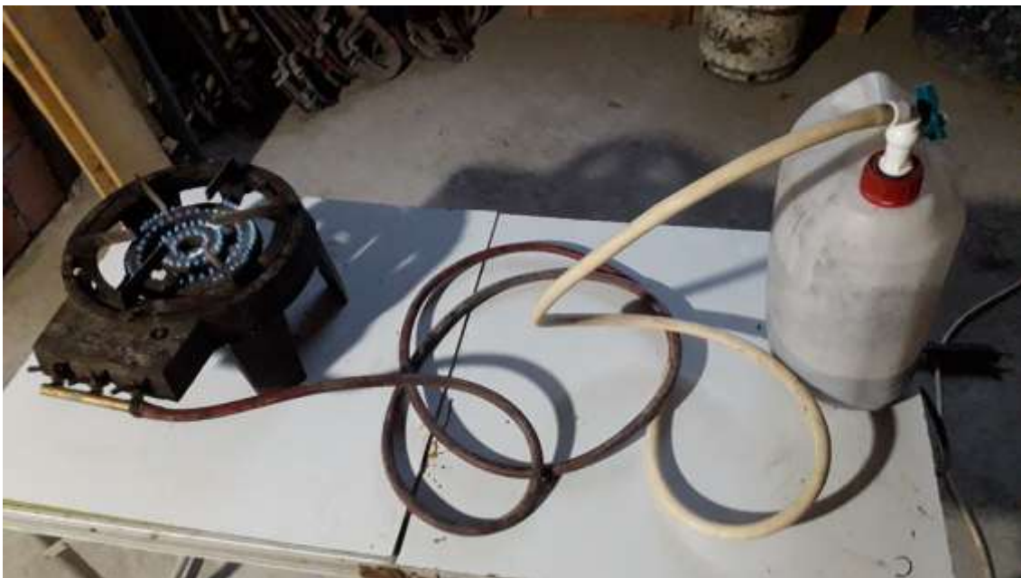
Figure 25 : Test du biogaz produit avec l'allumage d'un trépied gaz.
