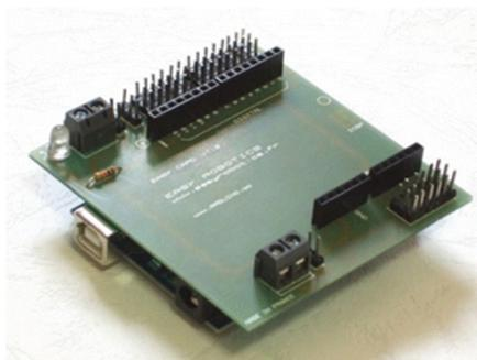
Figure IV.3 : Enficher l'EasyCard sur la carte Arduino
