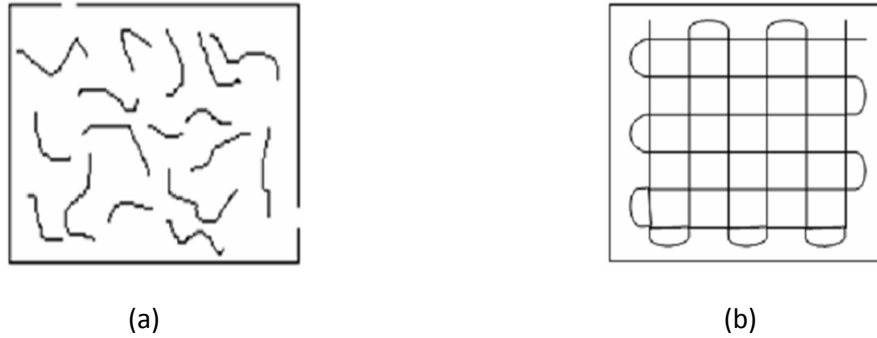
Figure I.3 : Formes de mats : (a) mat à fibres courtes, (b) mat à fibres continues.
