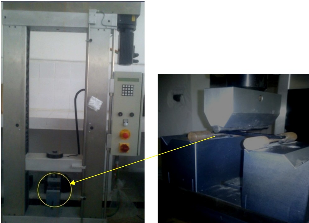
Figure V.5 : dispositif assurant l'essai de flexion
