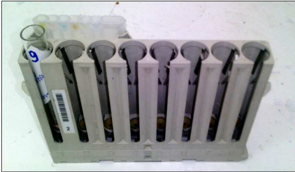
Figure 13: Portoir et barrette de dilution de l'électrophorèse capillaire.
