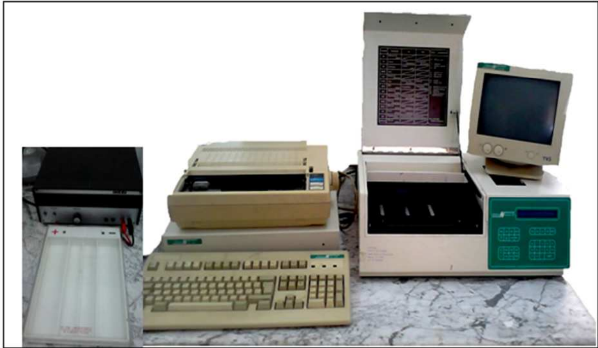
Figure 12 : Appareil d'électrophorèse sur acétate de cellulose : chambre de migration et densitomètre
