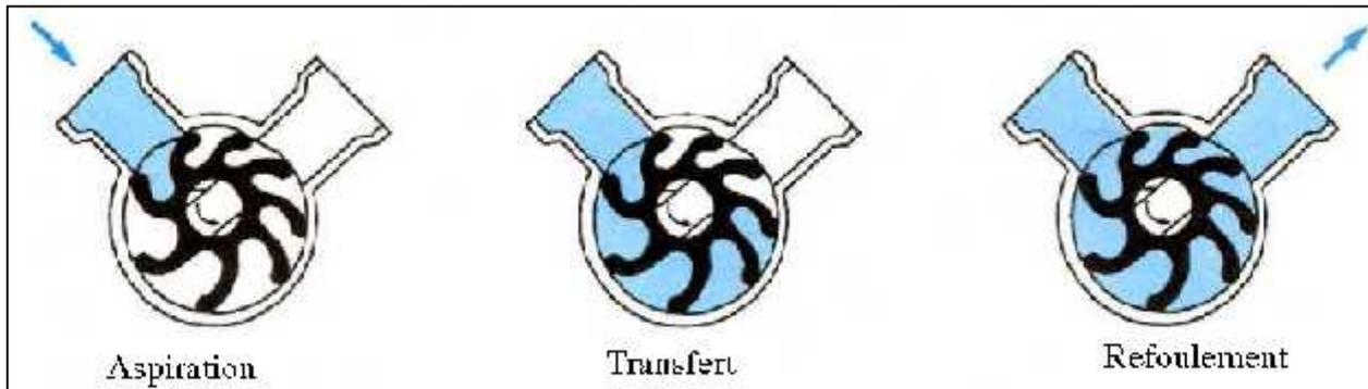
Figure II.9. Pompes à palettes flexibles
