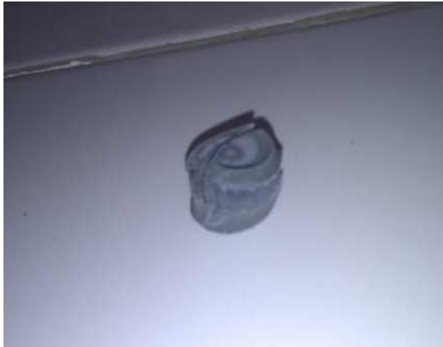
Figure VI.4 : Echantillon fritté à 1100°C d'un mélange Fe1 et Al.
