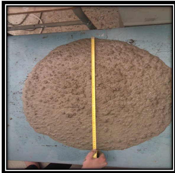
Figure II- 3 : Résultat d'essai d'étalement.
