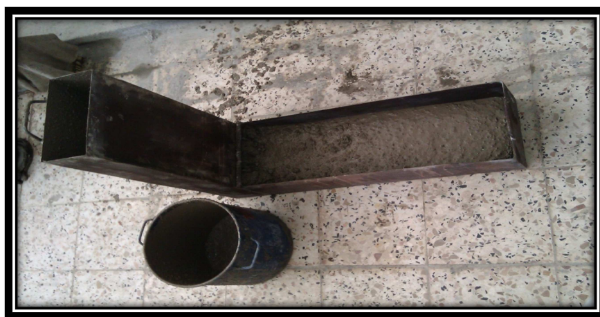
Figure II- 4: Résultat d'essai de la boîte en L
