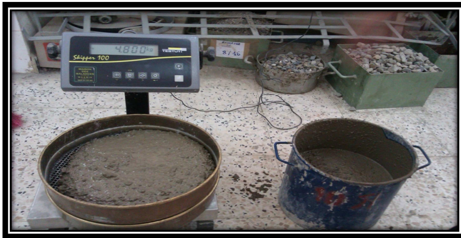
Figure II- 5: Photo descriptive de l’essai de stabilité au tamis (le tamis est de 5 mm).
