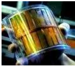
FIGURE 3.11 – A gauche : Cellule solaire à base d'un dérivé de PPV et de fullerène conçue par l'équipe de S. Sariciftci ; à droite : Film photovoltaïque organique produit par Mitsubishi Chemical.
