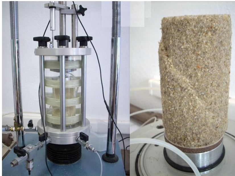
Figure.I.9 Echantillon d'un sol sous sollicitation mécaniques (Essai triaxial) avec apparition d'une bande de cisaillement.
