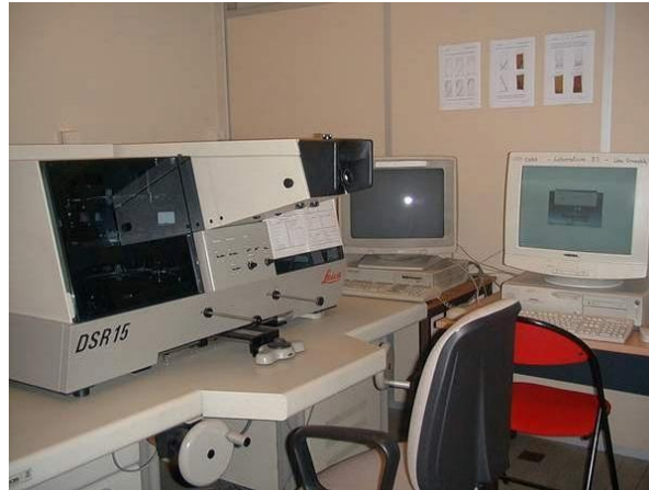
Figure.II.6 Stéréocomparateur (DSR15 Leica) et logiciel interactif d'exploitation par la méthode de faux relief.
