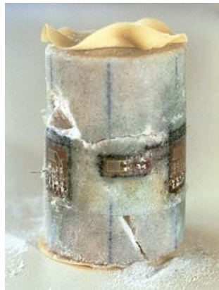
Figure.II.7 Echantillon d'une roche avec des jauges d'extensométrie entouré avec du ruban adhésif.
