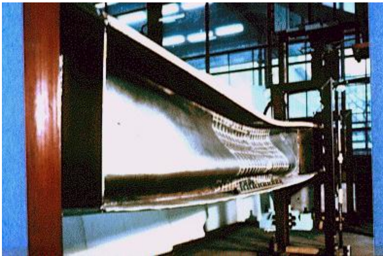
Figure.I.8 Poutre métalliques soumise à une compression avec l'apparition d'une déformation localisée.
