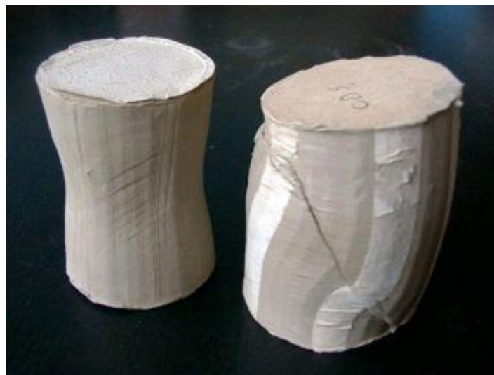
Figure.I.10 Deux échantillons d'argiles testés sous confinement au triaxial axisymétrique, l'un en extension (à gauche) et l'autre en compression.
